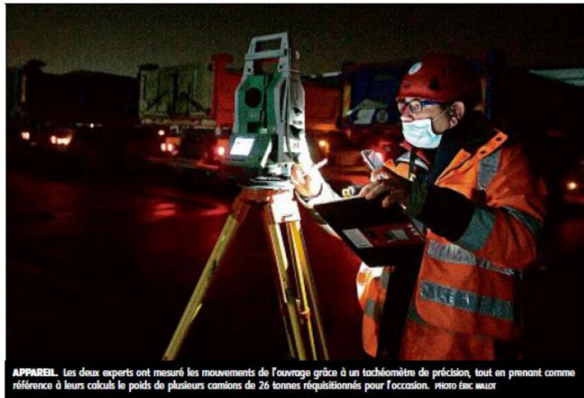
**APPAREIL.** Les deux experts ont mesuré les mouvements de l'ouvrage grâce à un tachéomètre de précision, tout en prenant comme référence à leurs calculs le poids de plusieurs camions de 26 tonnes requisitionnés pour l'occasion. PHOTO ERIC MALOT
